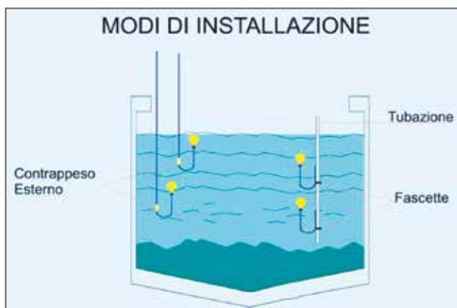
Il contrappeso si inserisce direttamente sul cavo di uscita dell'interruttore galleggiante.
